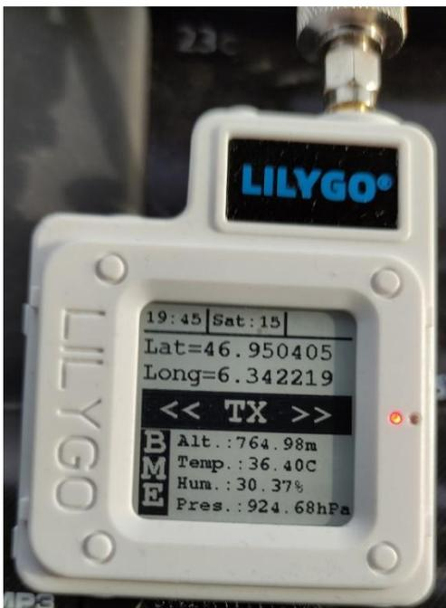
Wie schon zuvor geschrieben, ist der T-ECHO mit optionalem BME280 erhältlich. Dieser ist dann fest auf der Platine verlötet und damit auch im Gehäuse eingebaut. Damit hat man den Nachteil, dass der Sensor nicht wirklich die Umgebungswerte misst, sondern die Werte innerhalb des Gehäuses. Das ist nicht unbedingt gewollt. Allerdings kann man auch etwas basten. Es gibt eine steckbare Platine, die es einem ermöglicht, diesen Sensor extern nachzurüsten.
