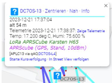
Ist ein I-Gate in der Nähe, werde die Informationen des CUBE, inklusive der Telemetrie-Daten, auf der Karte von APRS-IS<sup>4</sup> dargestellt. Die Höhenangabe wird immer dann übertragen, wenn das komprimierte Datenformat verwendet wird. Dieses ist der Fall, wenn für das APRS Symbol eines aus den Standard-Symboltabellen, „/“ und „\“, verwendet wird.
